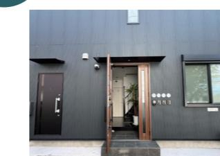
東京 23 区内では、ほぼ全域が防火または準防火地域に指定されており、リフォームにおいても外壁の防火性能が求められます。防火サイディングは、地震時の建物の揺れや変形にも柔軟に対応し、外壁にクラックが生じにくい構造です。
